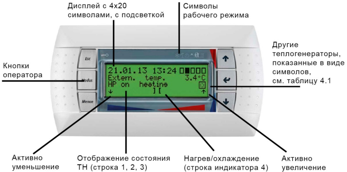
Рисунок 4.1 Контроллер теплового насоса со съемным основным ЖК-дисплеем с кнопками оператора
