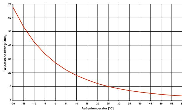
Abb. 7.2: Fühlerkennlinie NTC-10
