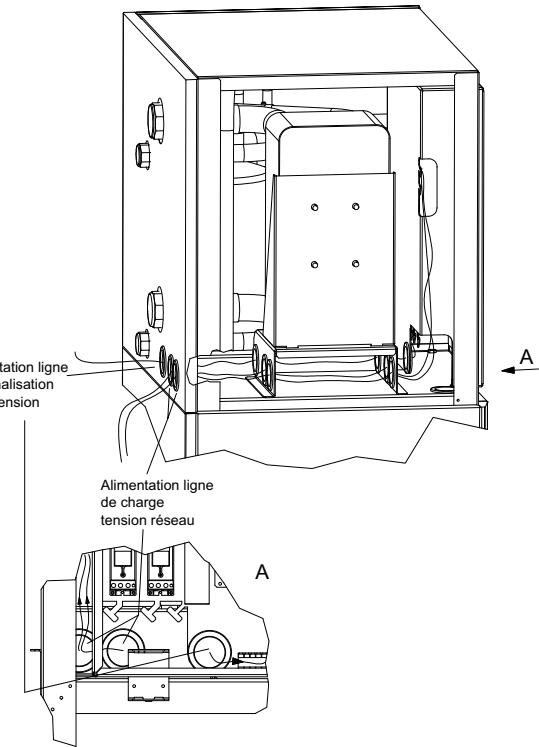
Fig. 7.4: Passage de câble du boîtier électrique
