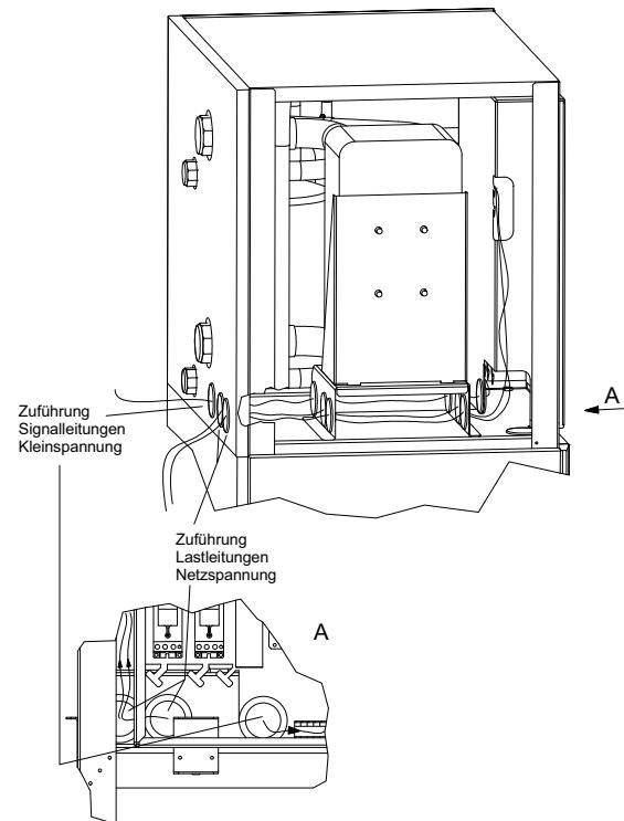
Abb. 7.4: Kabeleinführung Schaltkasten
