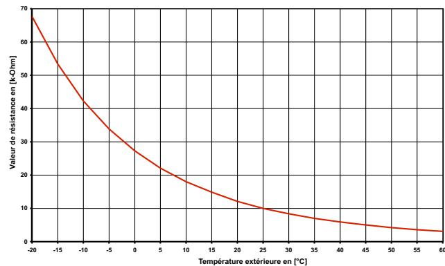
Fig. 7.2: Courbe caractéristique de la sonde NTC-10
