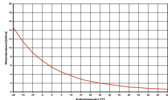
Abb. 7.3: Fühlerkennlinie NTC-2 nach DIN 44574 Außentemperaturfühler
